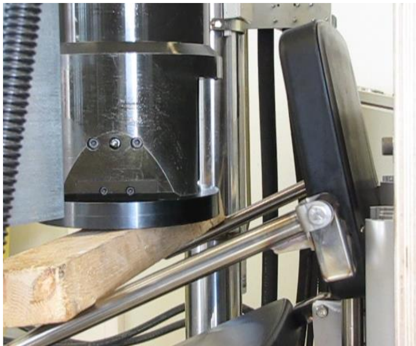
Kuva 18. ELITE-suihkuistuimen selkä- ja käsinojat n. 2,1 kN kuormituksessa
