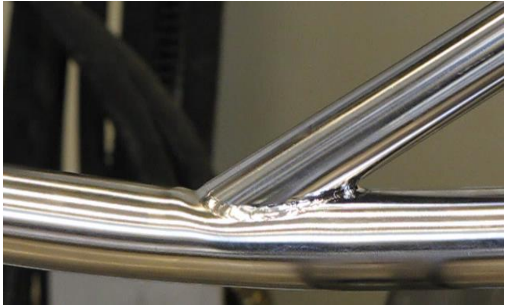
Kuva 11. PRIME-Tukikaide 1,9 kN kuormituksessa
