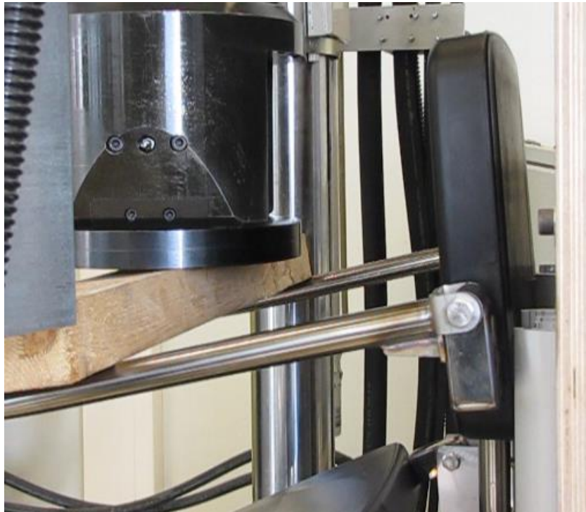
Kuva 17. ELITE-suihkuistuimen selkä- ja käsinojat n. 1,6 kN kuormituksessa
