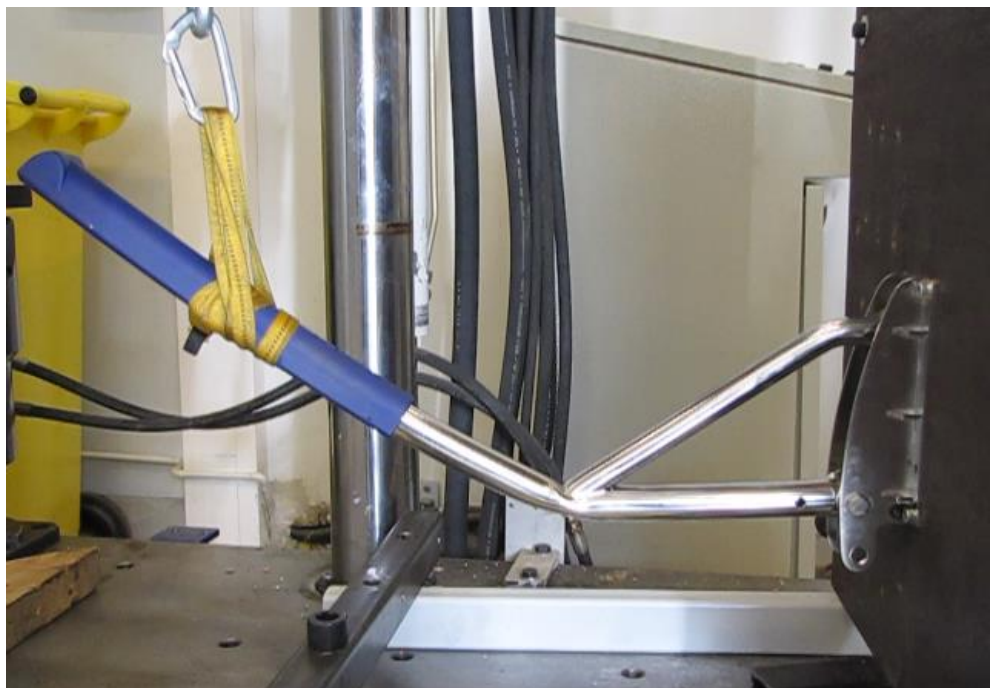
Kuva 12. PRIME-Tukikaide kuormituksen ylitettyä 3,2 kN
