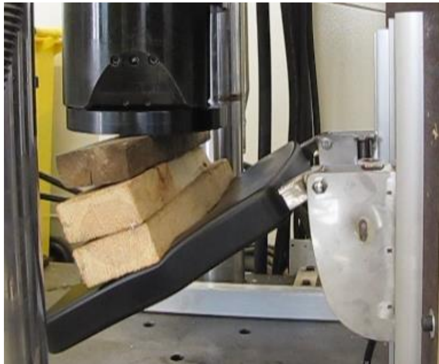
Kuva 16. ELITE-suihkuistuin n. 6,0 kN kuormituksessa
